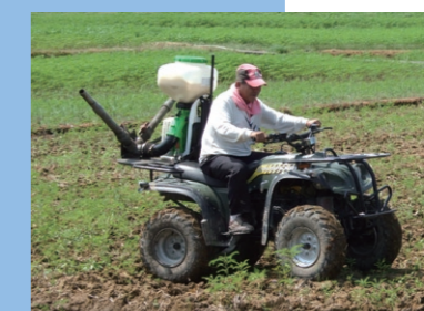
沙灘車搭載動力餌劑撒佈機
